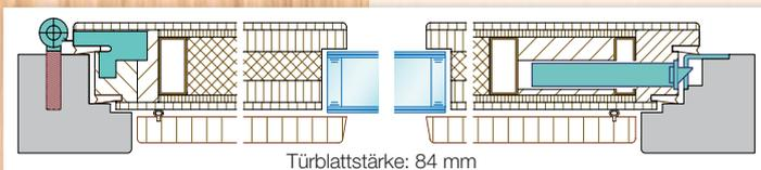
**Sicherheit** Integrierter, 4-seitig umlaufender Stahlrahmen · Schloß und Sicherheitsbänder im Stahlrahmen fest verschraubt · Serienmäßig eingebaute Mehrfachverriegelung · Schutzrosette mit Ziehschutz (außen) · Profilzylinder mit fünf Wendeschlüsseln
