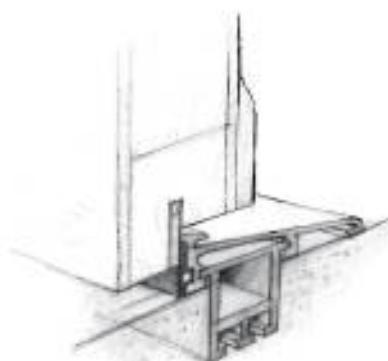
**Bodenanschluß für Alt- und Neubau mit wegnehmbaren Unterbau**
