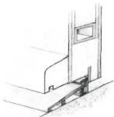
**Bodenanschluß für Alt- und Neubau ohne wegnehmbaren Unterbau**
