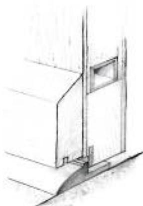
**Bodenanschluß zum Aufsatz auf durchgehende fertige Böden**
