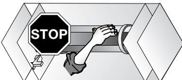
Es sollte möglich sein, den **Antrieb** durch **ab-bremsen** der Welle **ohne großen Kraftaufwand zu stoppen**.
